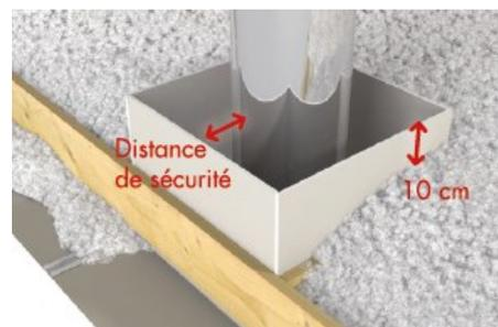
*Distances de sécurité à respecter pour un conduit de fumée et caisson de protection*
