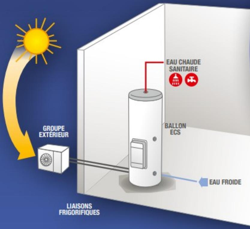
Contrairement au ballon d'eau chaude thermodynamique classique le «**Yutampo**» utilise un groupe extérieur de pompe à chaleur puissant, permettant une réelle production d'eau chaude à 55° **sans appoint électrique**
