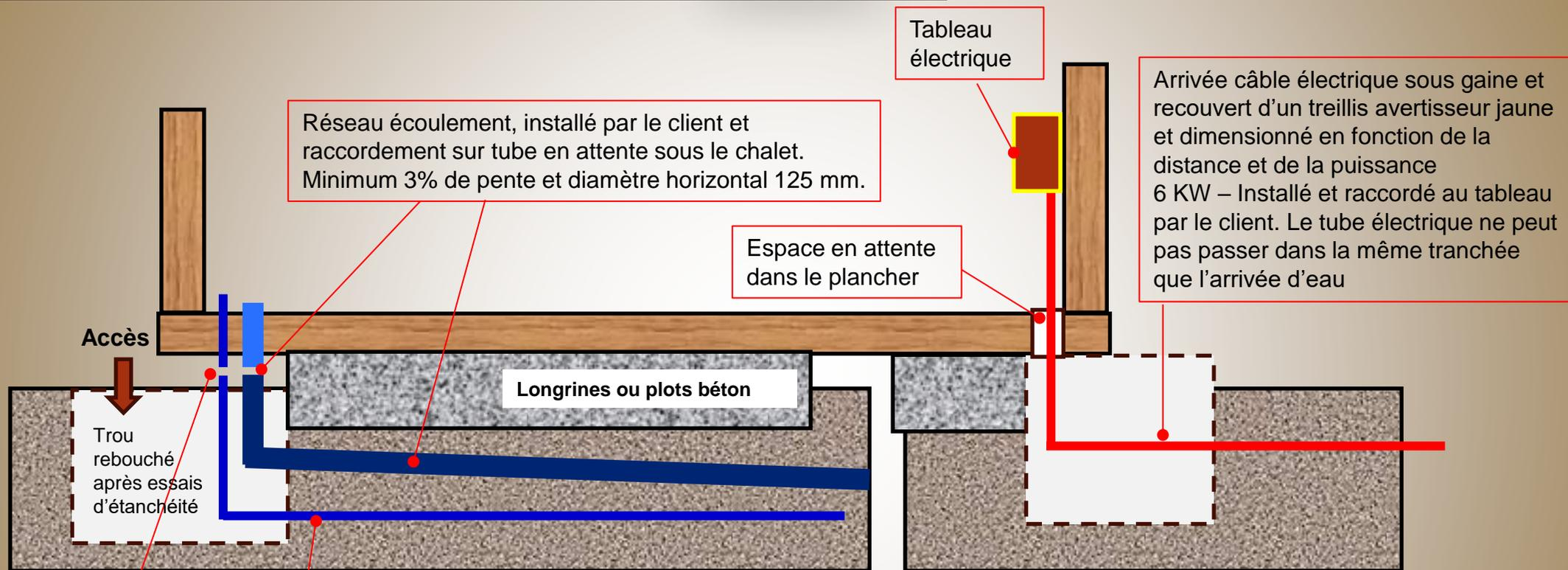
Réseau écoulement, installé par le client et raccordement sur tube en attente sous le chalet. Minimum 3% de pente et diamètre horizontal 125 mm.
