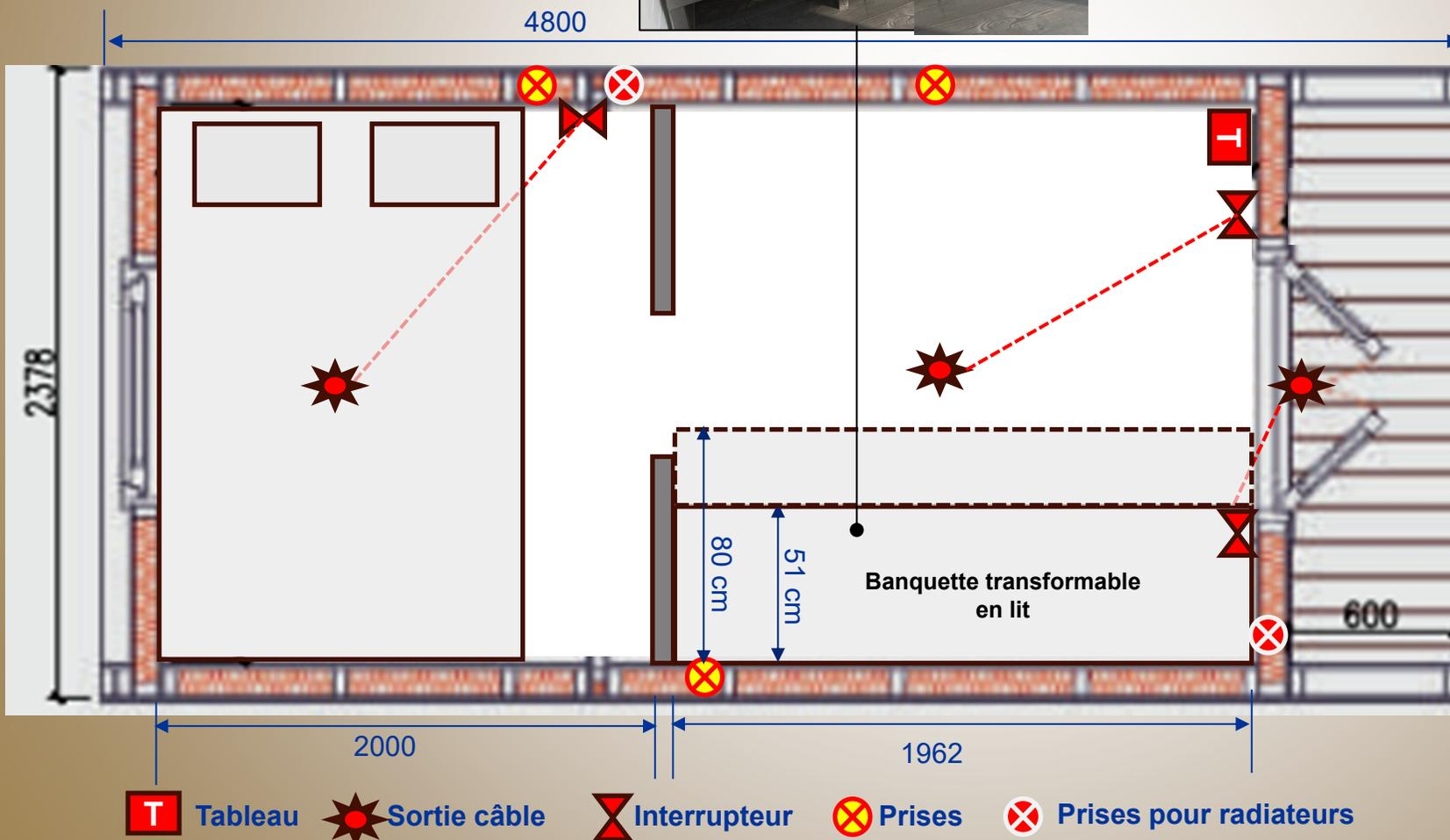
**T** Tableau   Sortie câble   Interrupteur   Prises   Prises pour radiateurs
