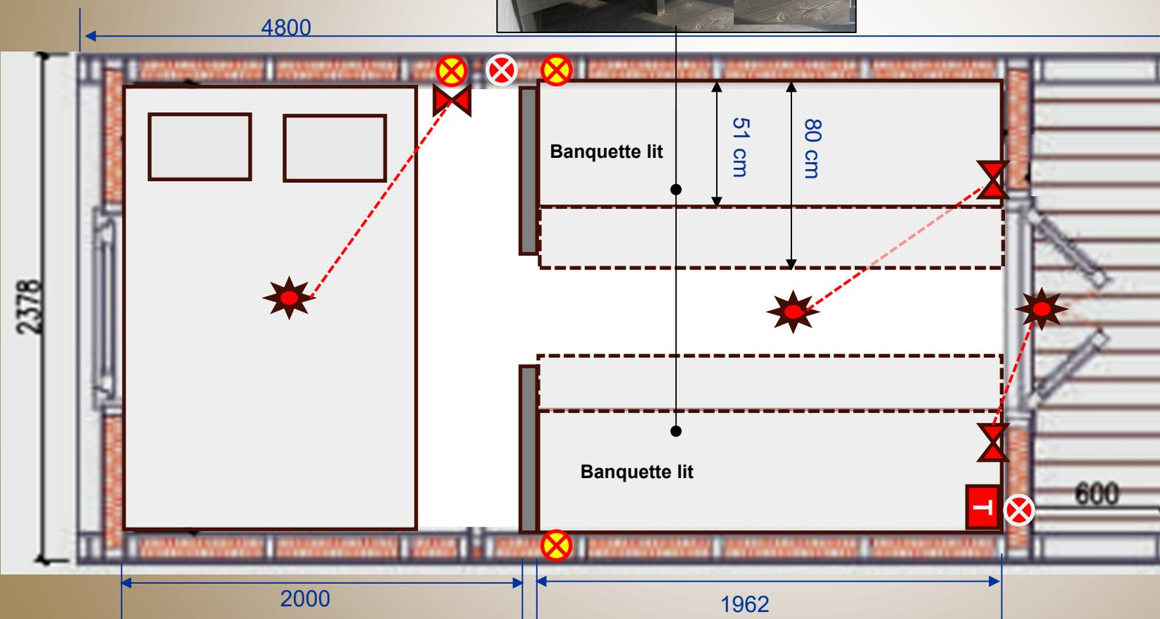
**T** Tableau   Sortie câble   Interrupteur   Prises   Prises pour radiateurs
