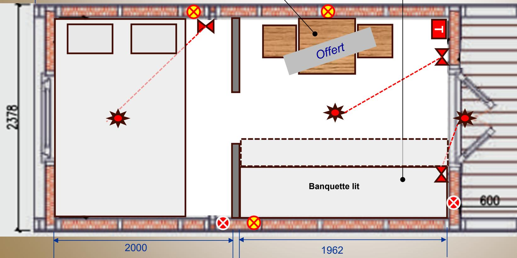
**T** Tableau   **Sortie câble**   **Interrupteur**   **Prises**   **Prises pour radiateurs**
