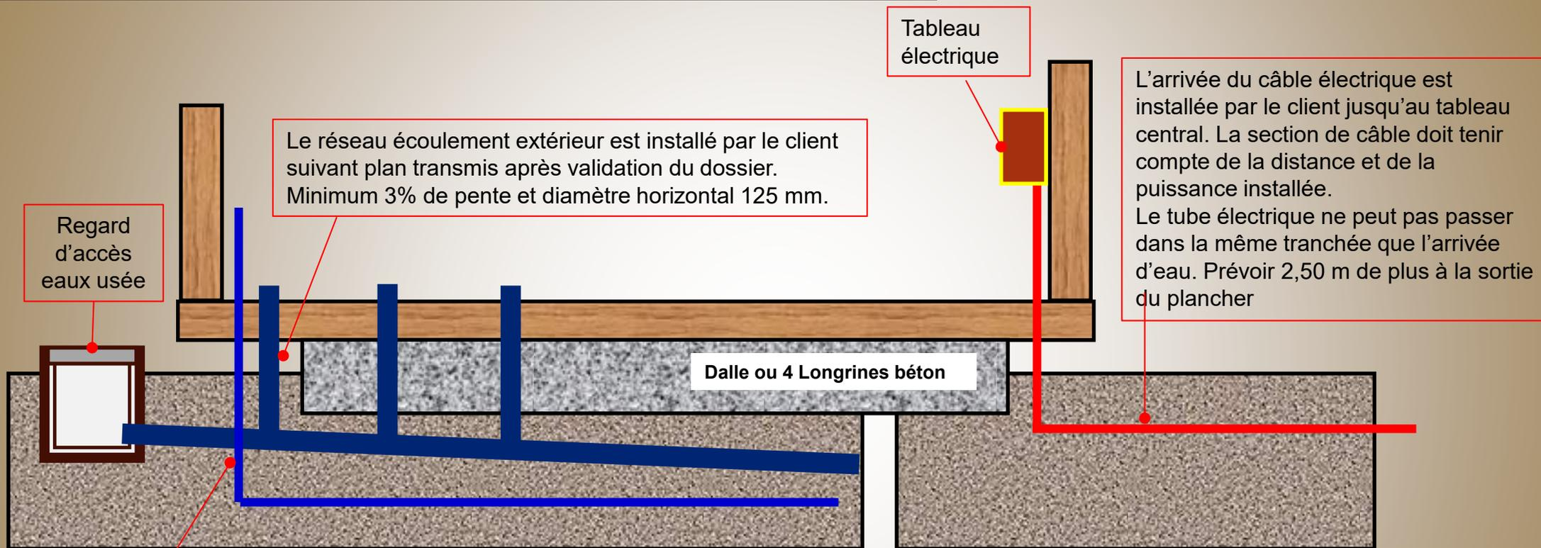
Le réseau écoulement extérieur est installé par le client suivant plan transmis après validation du dossier. Minimum 3% de pente et diamètre horizontal 125 mm.
